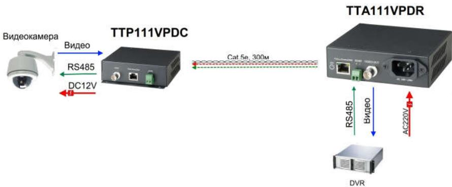
Рис.7 Схема подключения TTP111VPDC и TTA111VPDR
